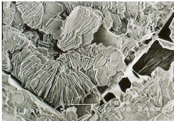
Au microscope électronique à balayage, certains minéraux argileux (ici la kaolinite) apparaissent formés de cristaux « en feuillets ».
